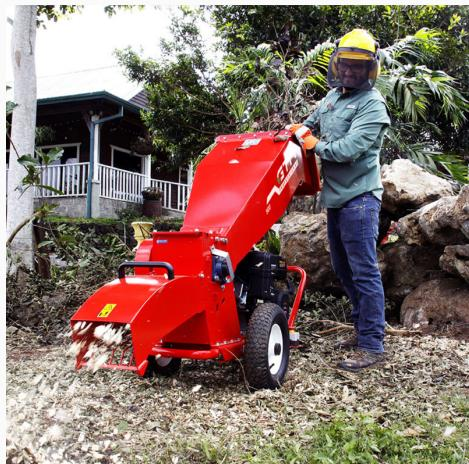
Trituradora de ramas y cultivos, compacta y poderosa. Ideal para empresas de jardinería, usuarios particulares muy exigentes. Tritura sin esfuerzo ramas de hasta 8 cm de diámetro gracias a su eficiente sistema de corte de dos cuchillas en un tambor rotativo de metal y una contracuchilla montada en el chasis.
