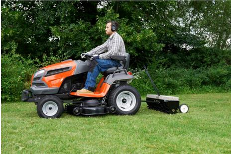
Husqvarna TS 142 es un tractor compacto de descarga lateral con un diseño inteligente y fácil de usar, desarrollado para su uso en jardines de tamaño pequeño a mediano. Equipado con transmisión hidrostática a pedal, asiento ajustable, cuenta horas y volante ergonómico.
